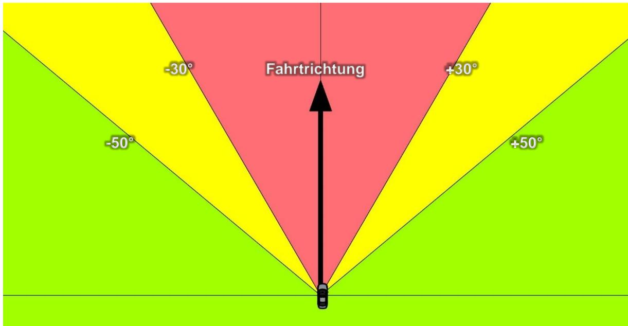
Abbildung 7: Definierte Sichtfelder eines Fahrzeugführers
